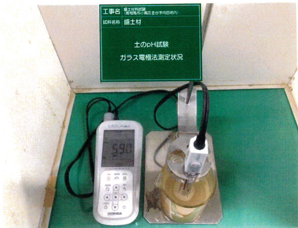
盛土材 土のpH試験( \text{H}_2\text{O} ) ガラス電極法測定状況
