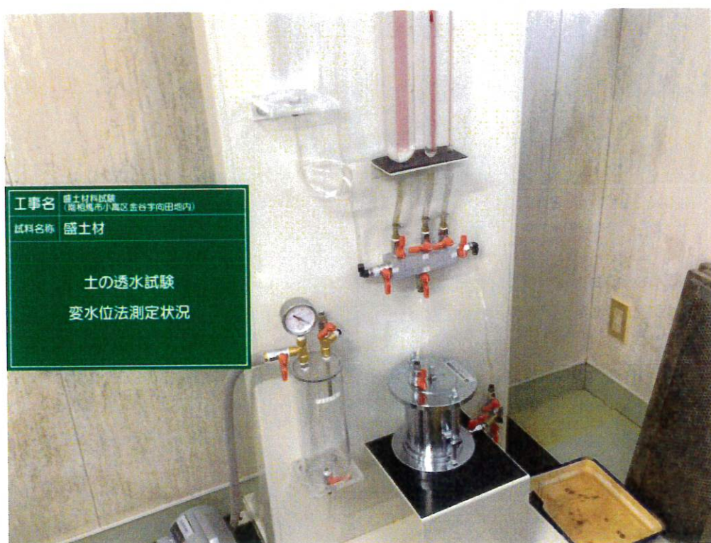
盛土材 土の透水試験 変水位法測定状況
