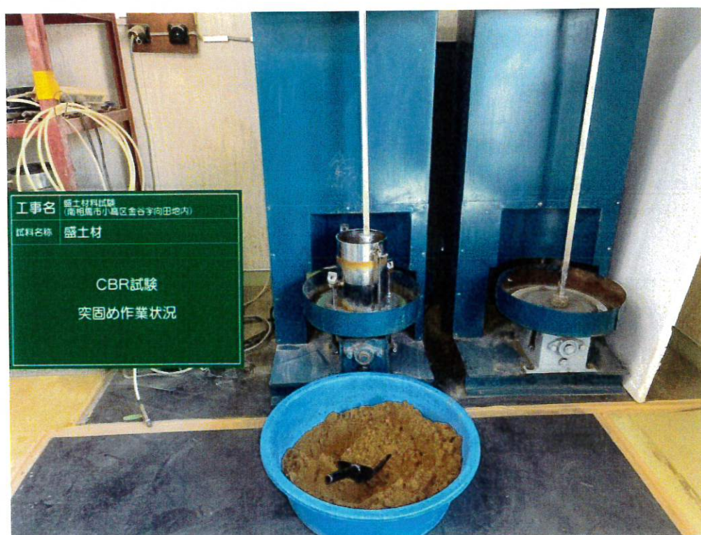
盛土材 C B R 試 験 突 固 め 作 業 状 況
