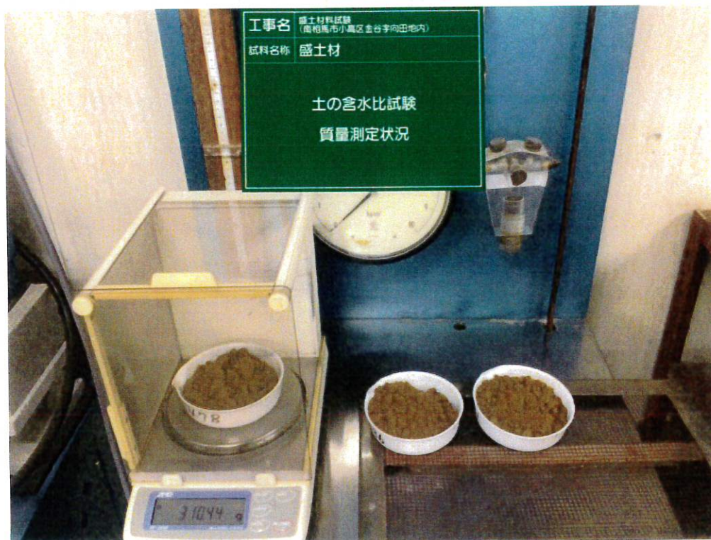
盛土材 土の含水比試験 質量測定状況
