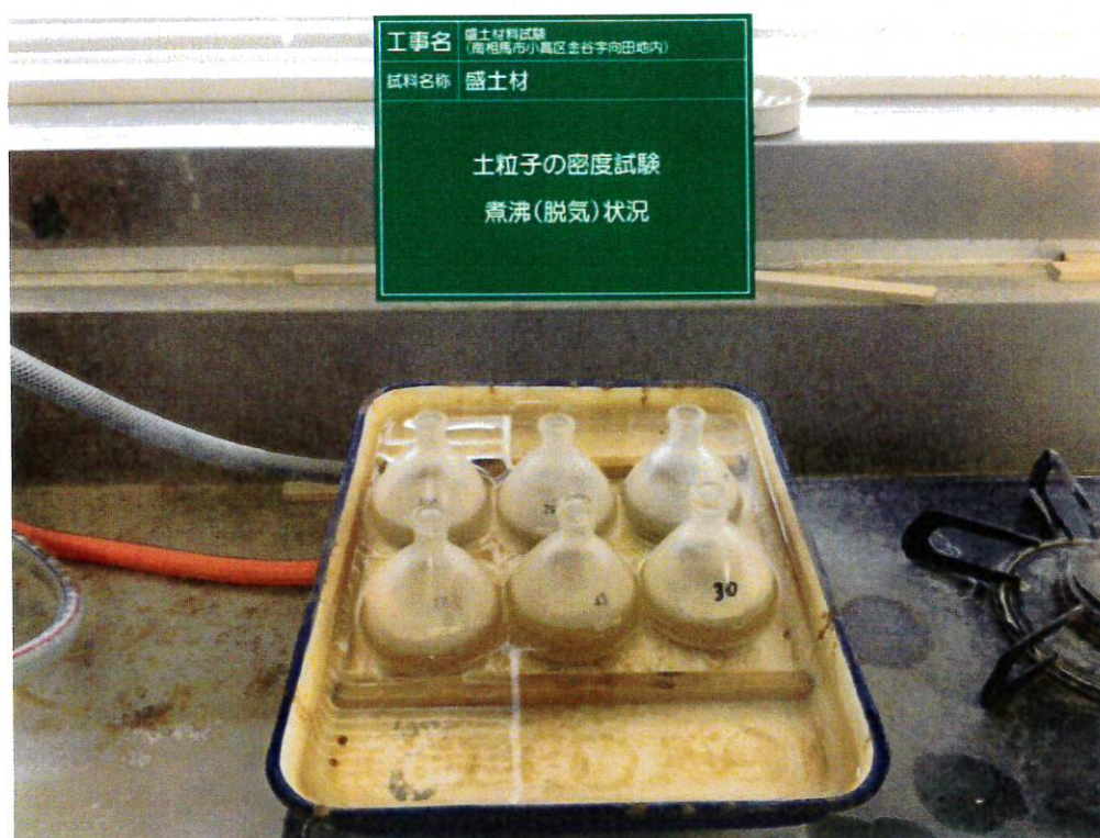
盛土材 土粒子の密度試験 煮沸(脱気)状況
