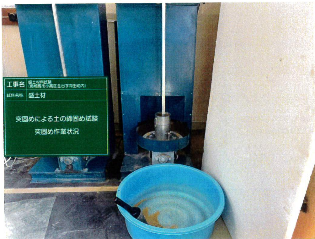
盛土材 突固めによる土の締固め試験 突固め作業状況
