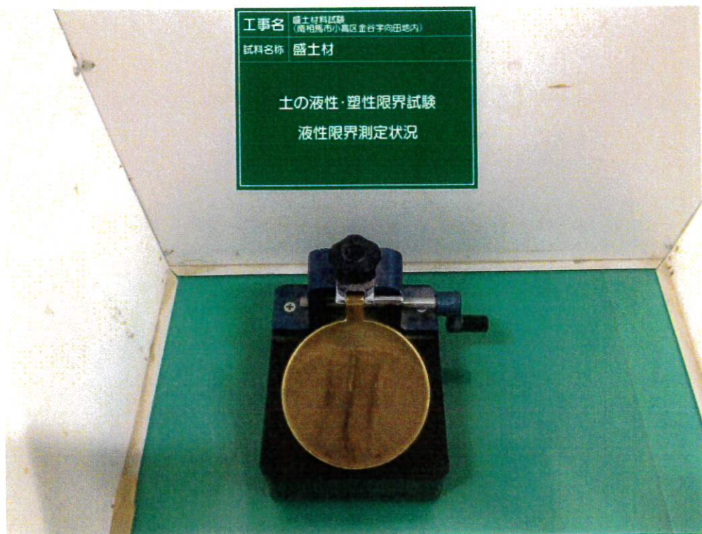
盛土材 土の液性・塑性限界試験 液性限界測定状況
