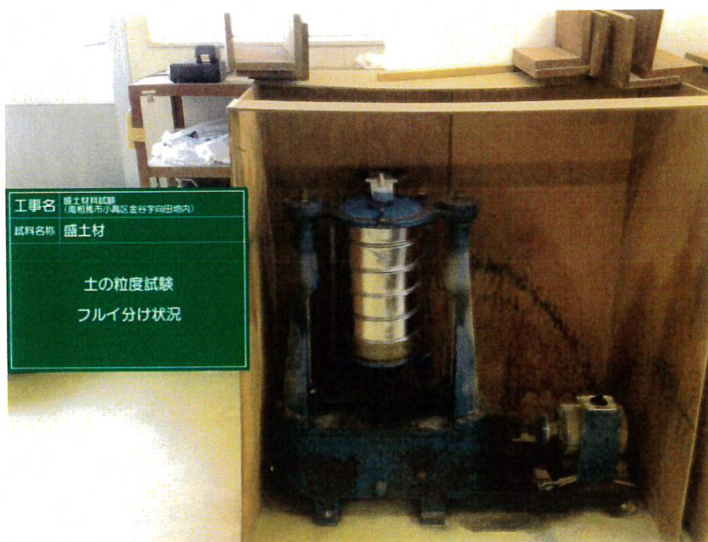
盛土材 土の粒度試験 ふるい分け状況
