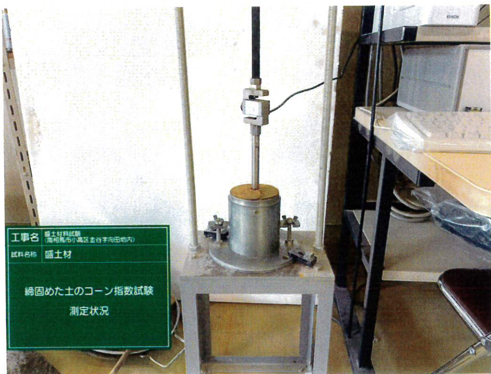
盛土材 締固めた土のコーン指数試験 測定状況
