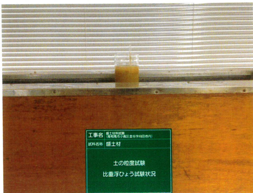
盛土材 土の粒度試験 比重浮ひょう試験状況
