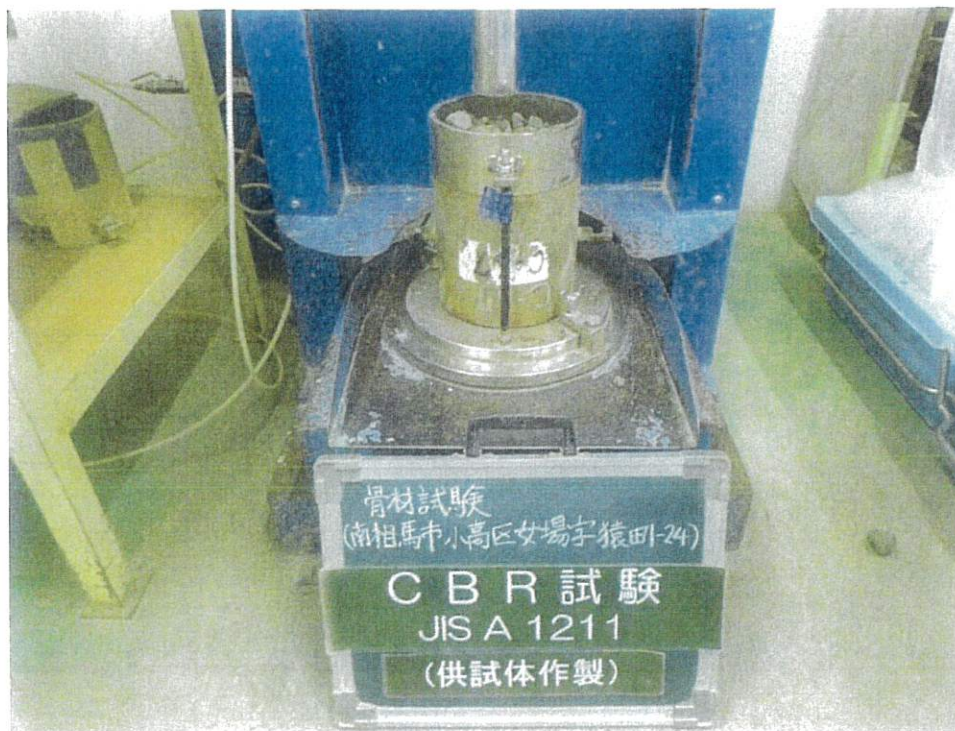
RC-40 C B R 試 験 突 固 め 作 業 状 況
