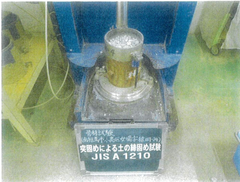
RC-40 突固めによる土の締固め試験 突 固 め 作 業 状 況
