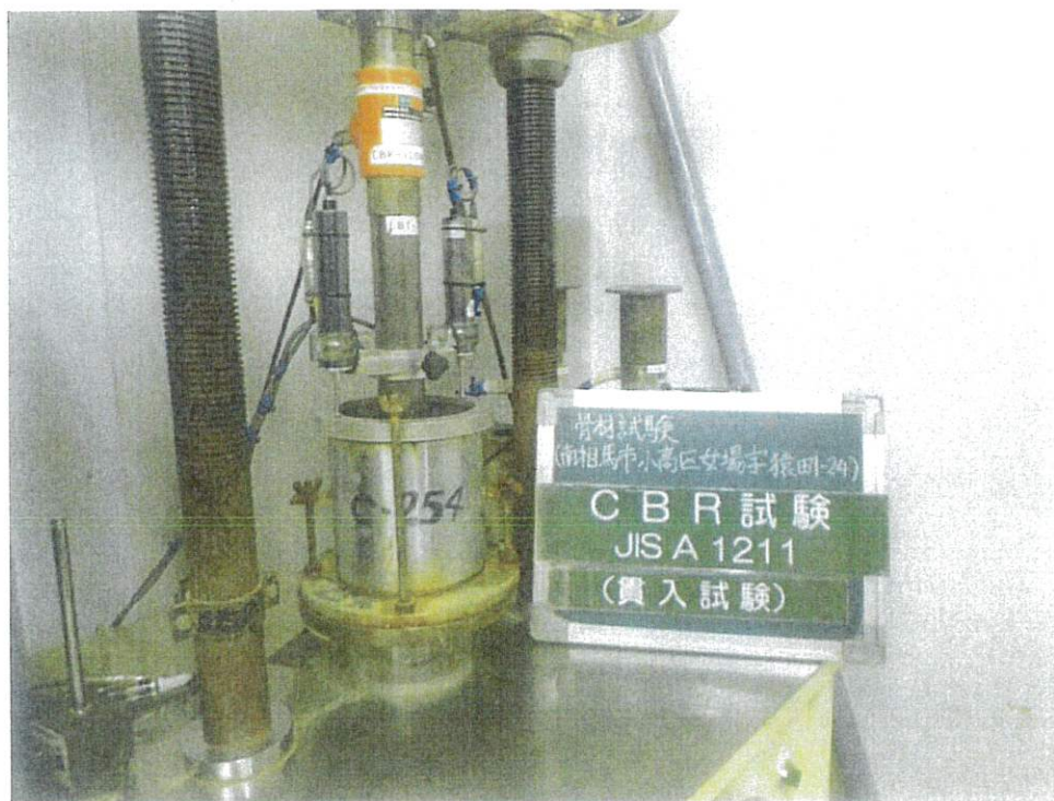
RC-40 C B R 試 験 貫 入 試 験 状 況
